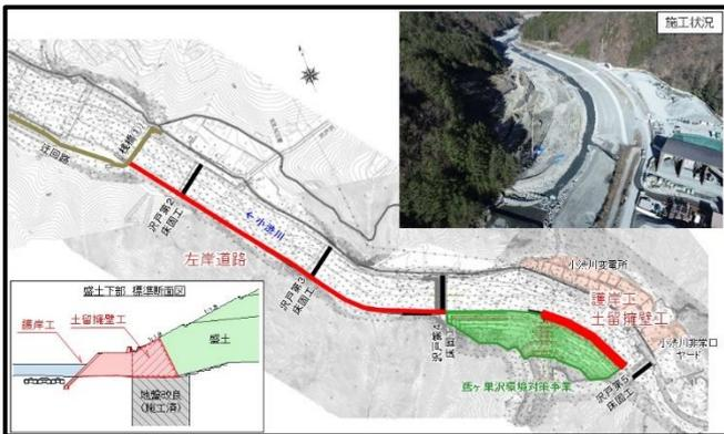
10月より工事を再開しました。現在は、河川内の仮締切工事が完了し、左岸道路の整備、鳶ヶ巣沢上流側の護岸工・土留擁壁を実施しています。
