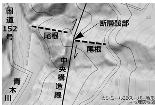
図1 引の田断層鞍部の尾根のずれ
