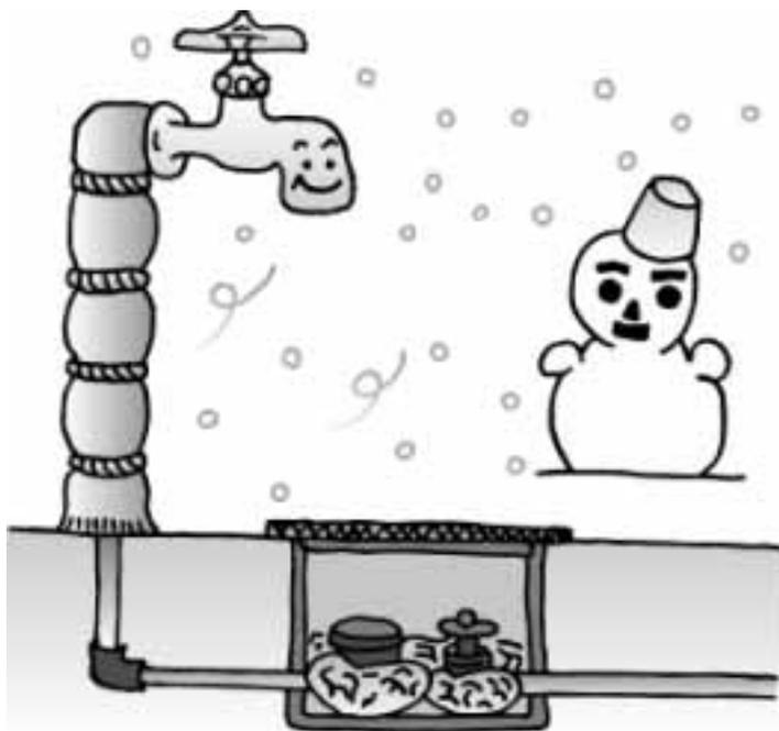
②メーターボックス内には、ビニール袋などに発砲スチロールや布切れなど保温材料を入れて、水道メーターを保護するように詰めてください。(布切れをそのまま入れてしまうと、濡れたときに凍結してしまい、かえってメーターを凍結させてしまうので、必ずビニール袋
